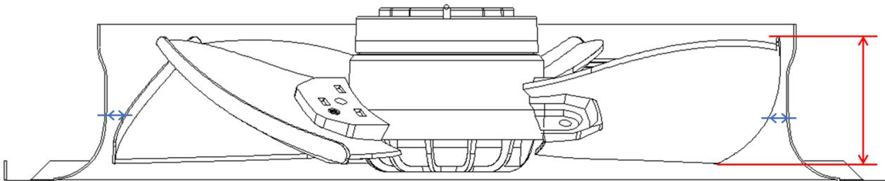
⇒ Beim Einbau ist zu prüfen, ob ein Berühren des Flügelrades ausgeschlossen ist. Sollte dies nicht der Fall sein, so muss ein normgerechter Berührungsschutz angebracht werden (Passende und geprüfte Schutzgitter sind bei uns als Zubehör erhältlich).
