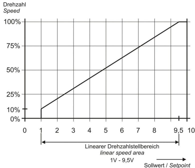
Der Drehzahlsollwert lässt sich durch ein angeschlossenes Potentiometer / Analogsignal stufenlos einstellen. Kleinere Spannungssignale als 1 Volt werden von der Elektronik als Stoppsignal ausgewertet. Bei einer Sollwertvorgabe von 9,5V erreicht der Ventilator die maximale Drehzahl.
