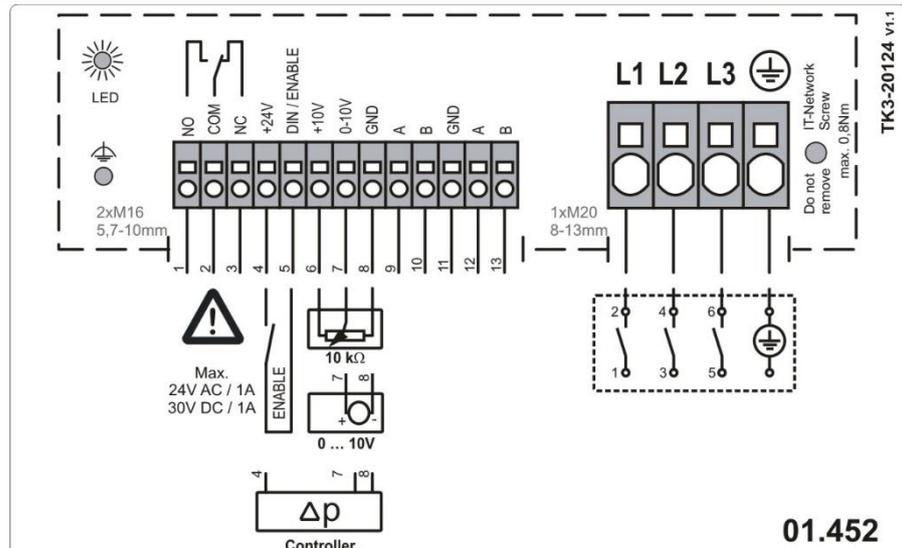
Die IT Netz Schraube ist nur bei der EC-Motor Baugröße GD 150 montiert
