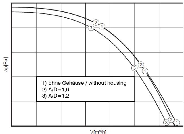
Saugseitig und druckseitig sollte ein Mindestabstand von  $0,5xD$  zu angrenzenden Bauteilen eingehalten werden. Damit können Einbauverluste vernachlässigt werden.
