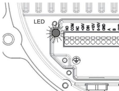
Die Elektronik ist mit einer zweifarbigen LED (im Klemmraum) zur Anzeige der unterschiedlichen Betriebszustände ausgestattet. Durch den transparenten Klemmraumdeckel ist die LED auch im Montierten Zustand der Abdeckung zu erkennen!
