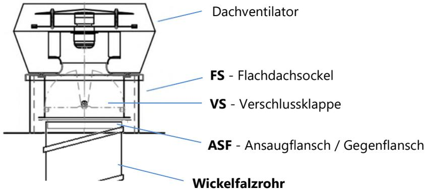
Aufbau in Verbindung mit einem **Sockelschalldämpfer (SD)**
